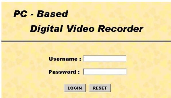
如果透過 **ChateauServer** 的網頁伺服器，在 IE 網址列鍵入 <http://192.168.16.107:8080>（連接 **ChateauServer** 使用 8080 通訊埠，此處的 IP 位址只是說明使用的範例，請使用者依據您自己實際的網路 IP 位址來做設定），如果使用網際網路的浮動式實體 IP，也申請了動態網域名稱，在 IE 網址列可直接輸入申請的動態網域名稱，加上:8080，進入下圖之畫面：
