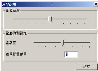
**影像品質：**此功能為影像品質的調整，以滑鼠左鍵按住拖曳棒往左調低或往右調高選擇想要的影像品質。高影像品質其影像壓縮率較低（資料量大），反之低影像品質其影像壓縮率較高（資料量小）。
