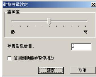
設定方式類似 **Chateau** 的動態偵測設定，設定完成後必須在**設定**命令下勾選**啟動動態搜尋**，功能才會啟動。然後在畫面播放時，使用滑鼠左鍵畫出偵測區域，最多可畫三個偵測區。畫好偵測區，程式會自動快轉搜尋偵測區畫面變動的時間點，如果勾選了**偵測到動態時暫停播放**，畫面會暫停，等待按下 **Play** 按鈕繼續搜尋。如果沒有勾選**偵測到動態時暫停播放**，畫面會恢復正常速度，直到動態結束再度快轉。左鍵在畫面上單擊一次，可取消所有的偵測區。
